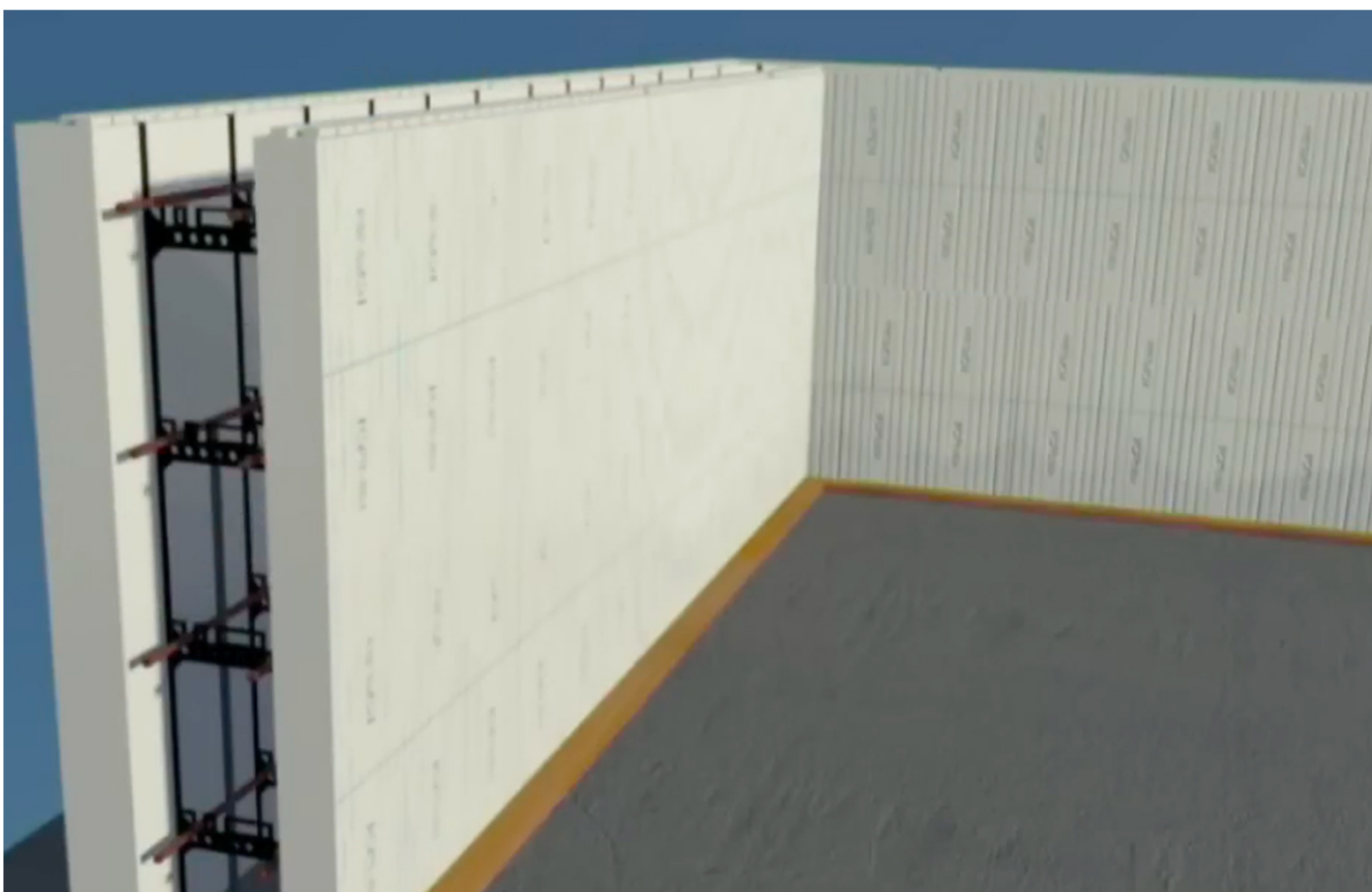
Pose des blocs suivants et des armatures
